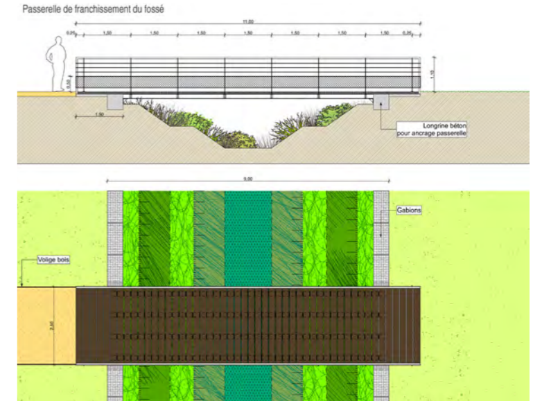
Passerelle de franchissement du fossé
